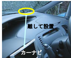
図 E GPS アンテナの設置(車室内)
