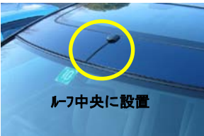
図 D GPS アンテナの設置(車室外)
