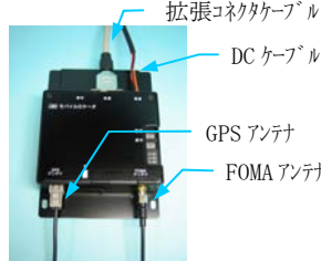
図 C 各種ケーブルの接続
